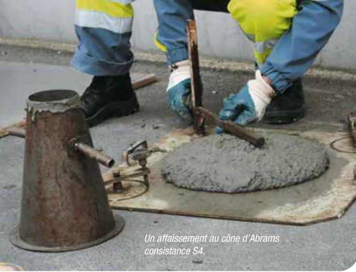
*Un affaissement au cône d'Abrams consistance S4.*
